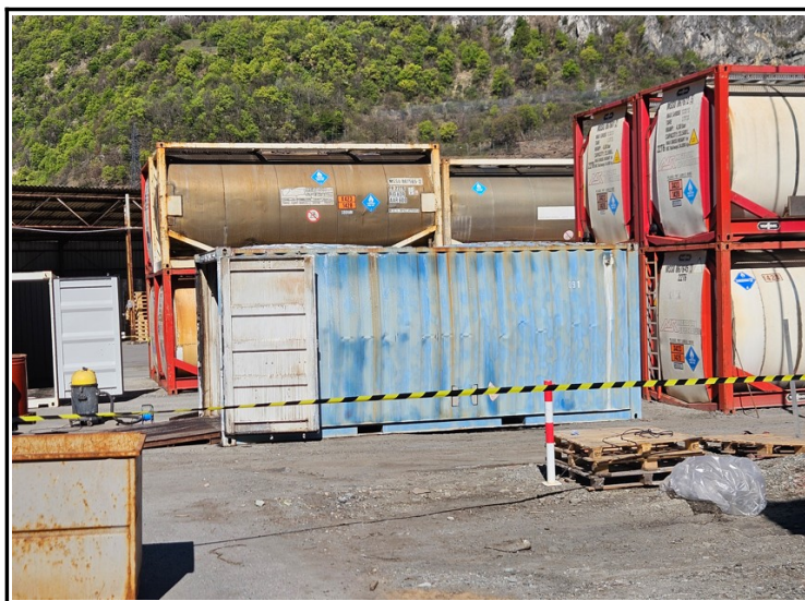
Container déformé par l'explosion
